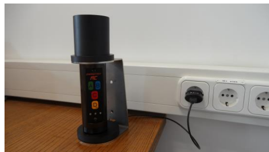
Ladegerät für Funkfernbedienung mit Inspektionslampe
